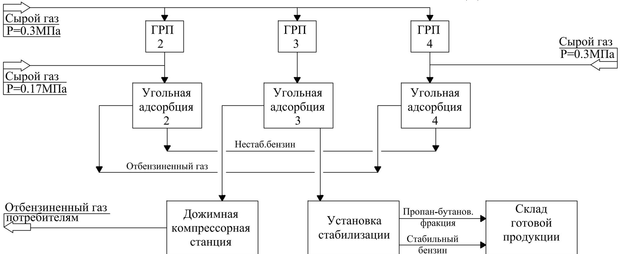
В состав Долинского газоперерабатывающего завода включены три производства: Долинское, Пасечнянское и Бориславское. Фактическая мощность Бориславского производства-180 млн.м<sup>3</sup>/год по газу, оно работает по схеме угольной адсорбции. В составе производства имеется установка битумно-резиновой мастики.
